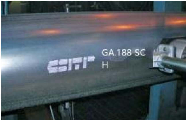
管道（钢管、塑料管等）的编码和标记
