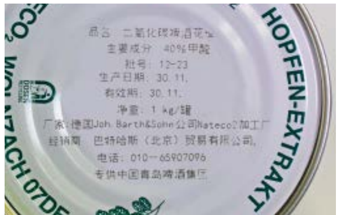
通过脱色法对马口铁罐进行编码和标记
