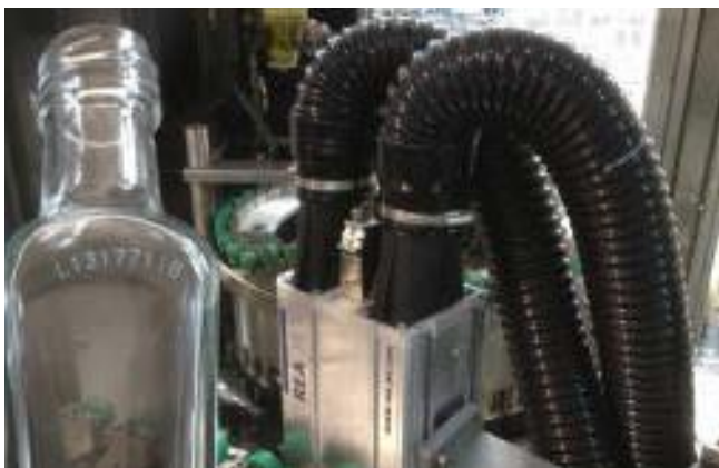
使用二氧化碳激光器对玻璃进行编码和标记 IP65
