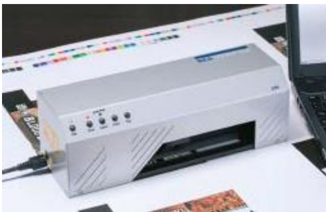
印刷样品纸上条形码的测量
