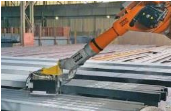
钢坯标记 - 机器人喷标块
