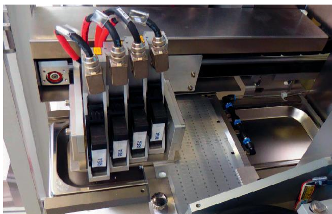
使用 4 个级联高分辨率打印头对吸塑包装进行编码
