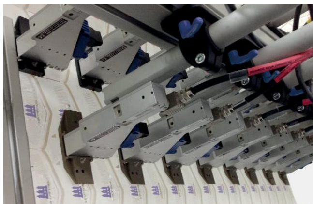
使用 16 个高分辨率打印头完成标签打印
