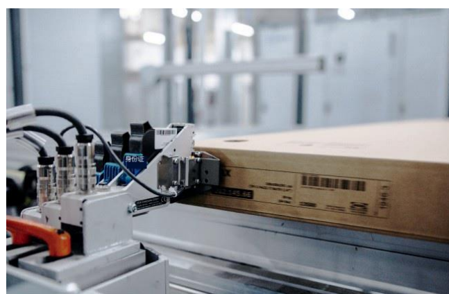
使用 3 个 REA JET HR 打印头更换标签
