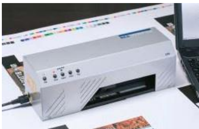
印刷样品纸上条形码的测量
